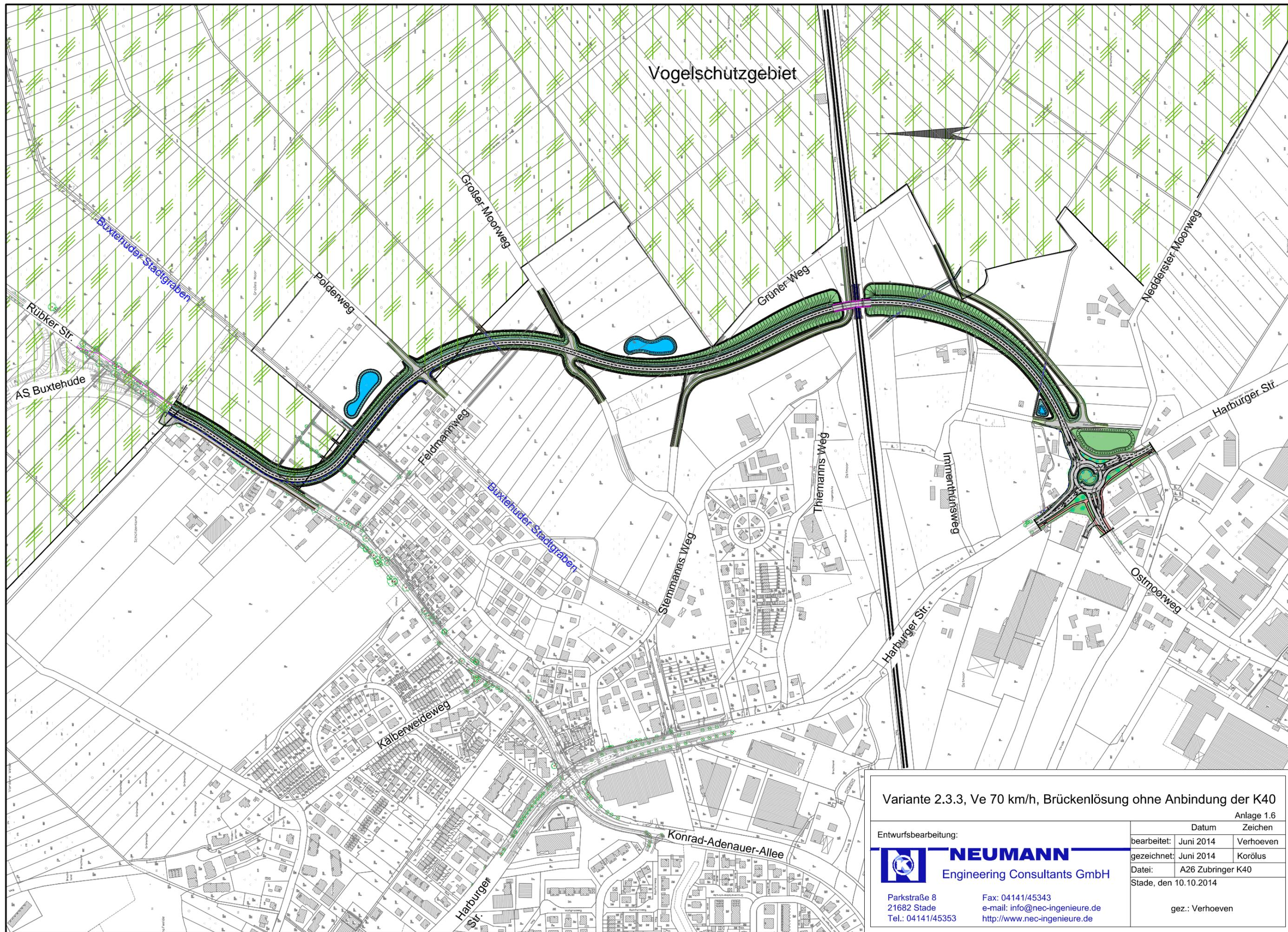
Variante 2.3.3, Ve 70 km/h, Brückenlösung ohne Anbindung der K40
